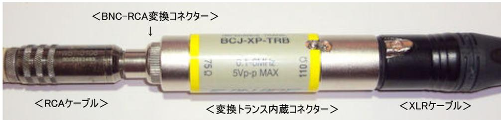
＜CANAREの変換トランス内蔵コネクタ(BCJ-XP-TRB)にケーブルを接続したところ＞
