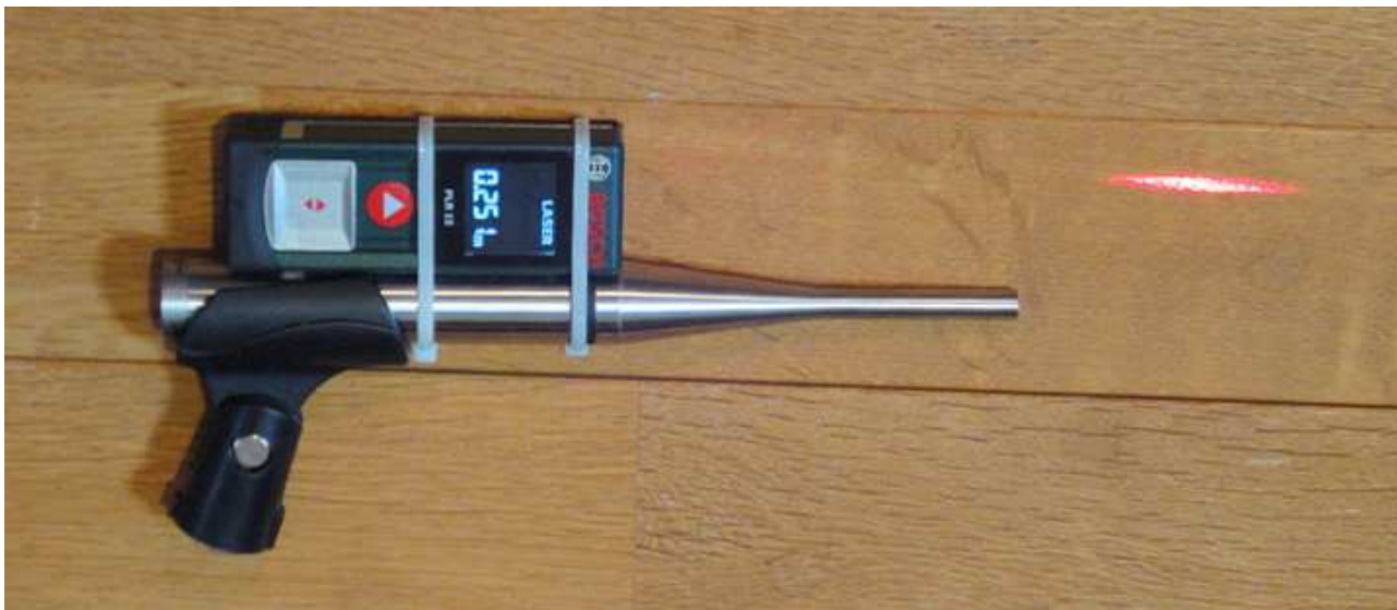
[写真 1] 測定マイク（M30）に PLR15 型レーザー距離計を取り付ける
