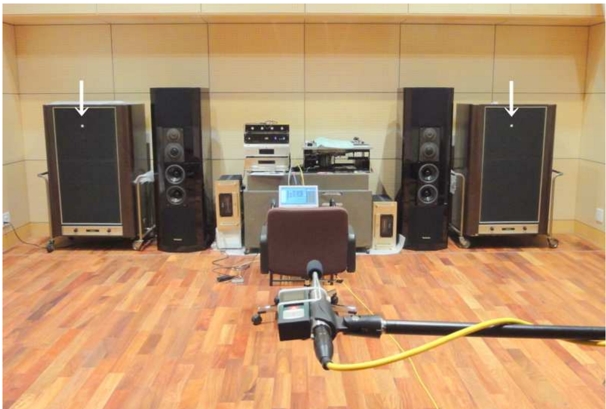
[写真3] 左右のスピーカーはレーザー反射用の白いビニールテープ（矢印）を貼って測定 （写真は試聴位置から壁までの距離を測定した時のもの）
